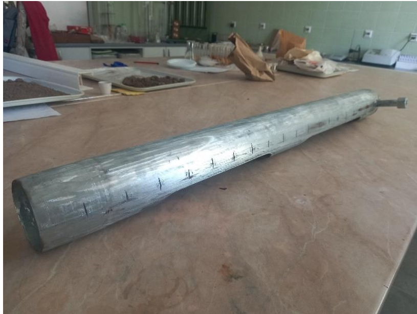
Slika 27. Izgled sonde sa ugraviranim oznakama dubine svakih 5 cm
